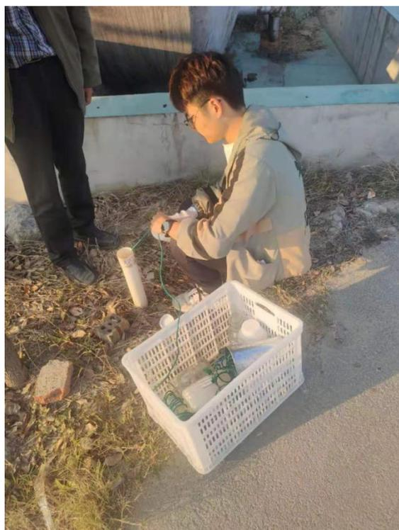
图 5-4 地下水监测井及水样采集
